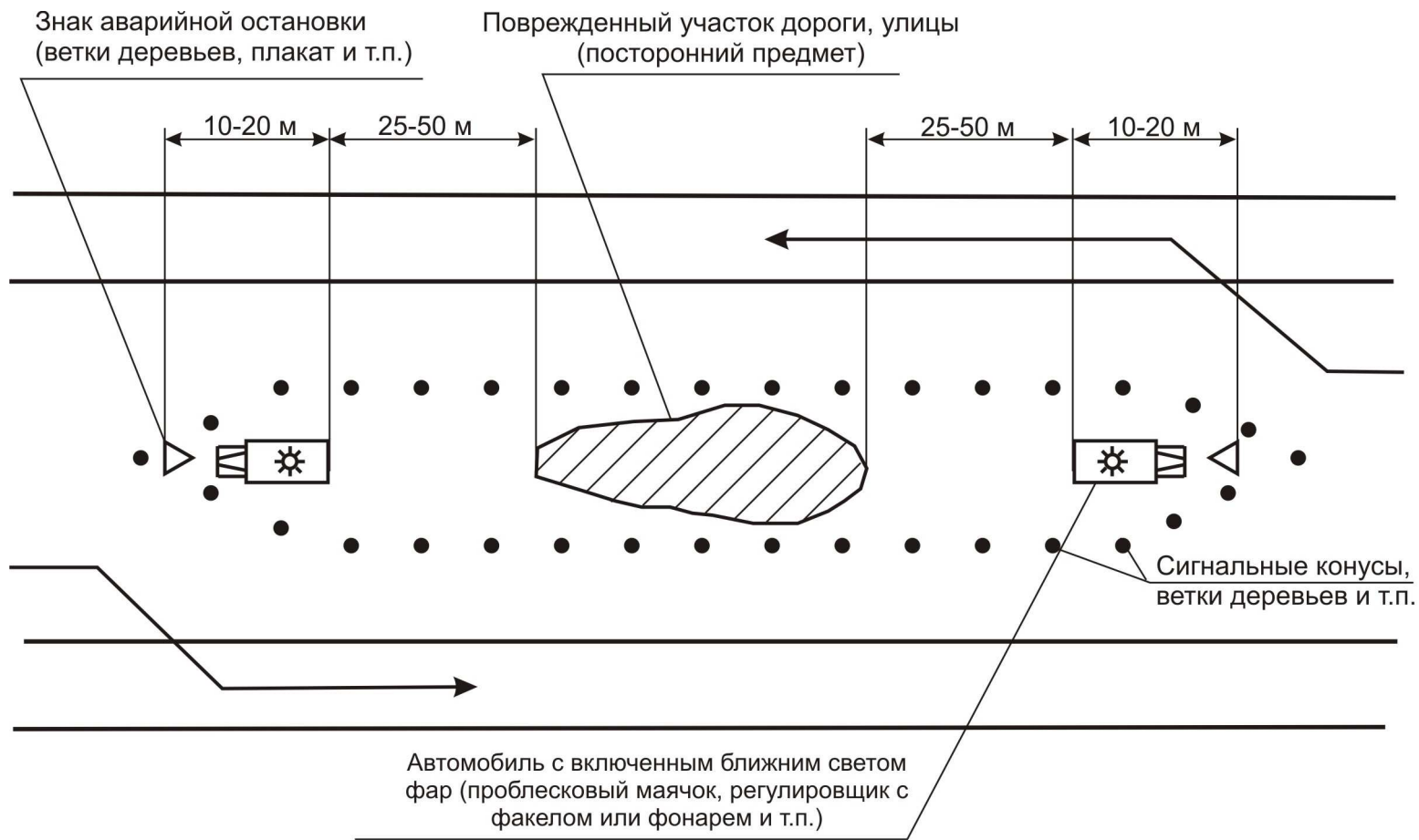
Рисунок Д.1 - Ограждение места производства аварийно-восстановительных работ
