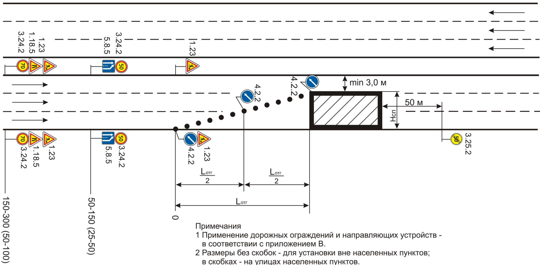
Рисунок Д.15 - Расстановка ТСОДД при производстве дорожных работ на правой стороне проезжей части многополосной дороги, улицы
